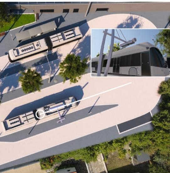
Le projet comprend l'acquisition de 40 nouveaux bus électriques de 18 m de long (avec une articulation). Capables d'embarquer 140 passagers, ils rechargeront leurs batteries au départ, à chaque terminus et, si nécessaire, à certaines stations équipées de mâts de charge. Le SMTC-AC a choisi le groupement Hess/Hitachi Energy pour mettre en place un système de transport reconnu pour sa fiabilité, son confort et la sécurité de ses batteries.
